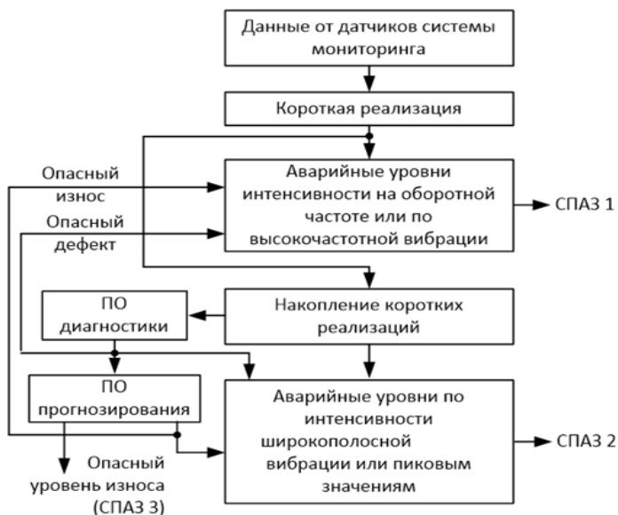
Рисунок 6 – Структура системы вибрационной противоаварийной защиты электромеханического оборудования
