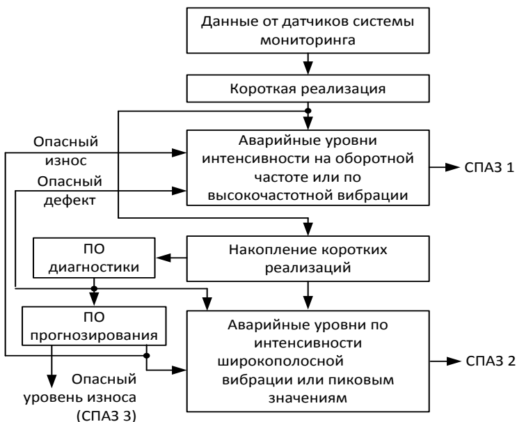
Рис. 2 – Структура сбора данных для системы противоаварийной защиты
