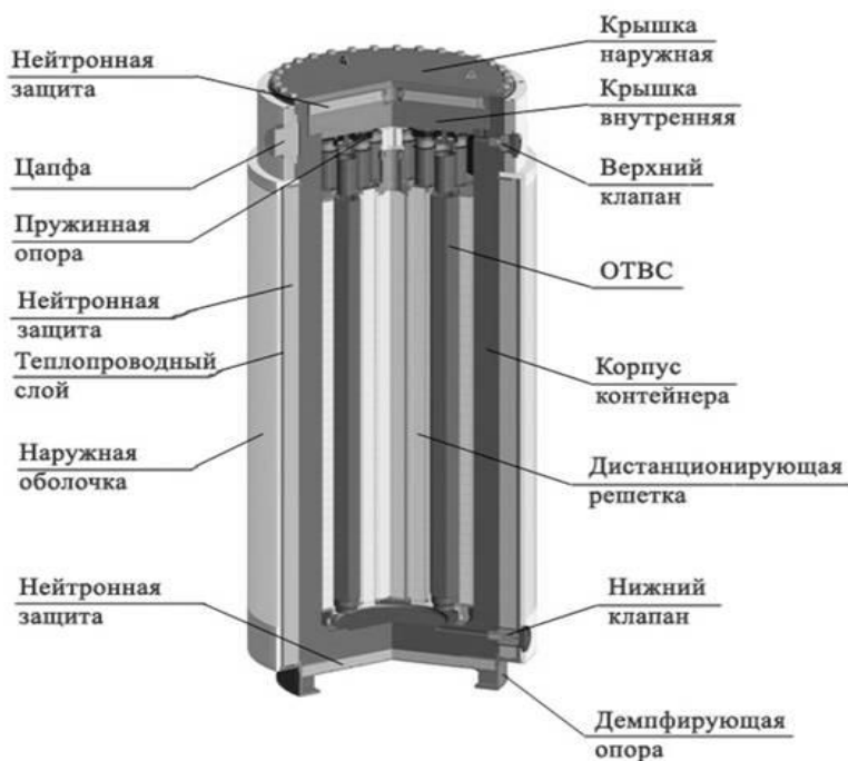
Рисунок 1 – Структурная схема транспортно-упаковочного комплекта для транспортировки и хранения отработавшего ядерного топлива (автор разработки: ОАО «Конструкторское бюро специального машиностроения»)
