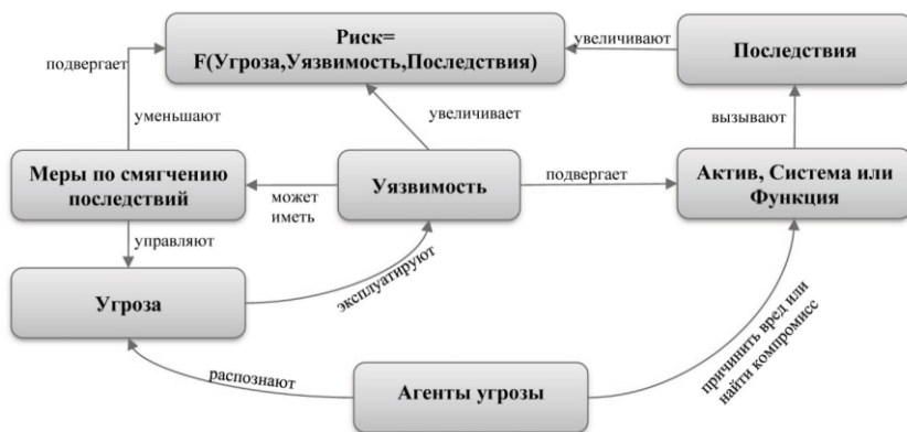
Рисунок 2 – Связь между риском, угрозами, уязвимостью и последствиями
